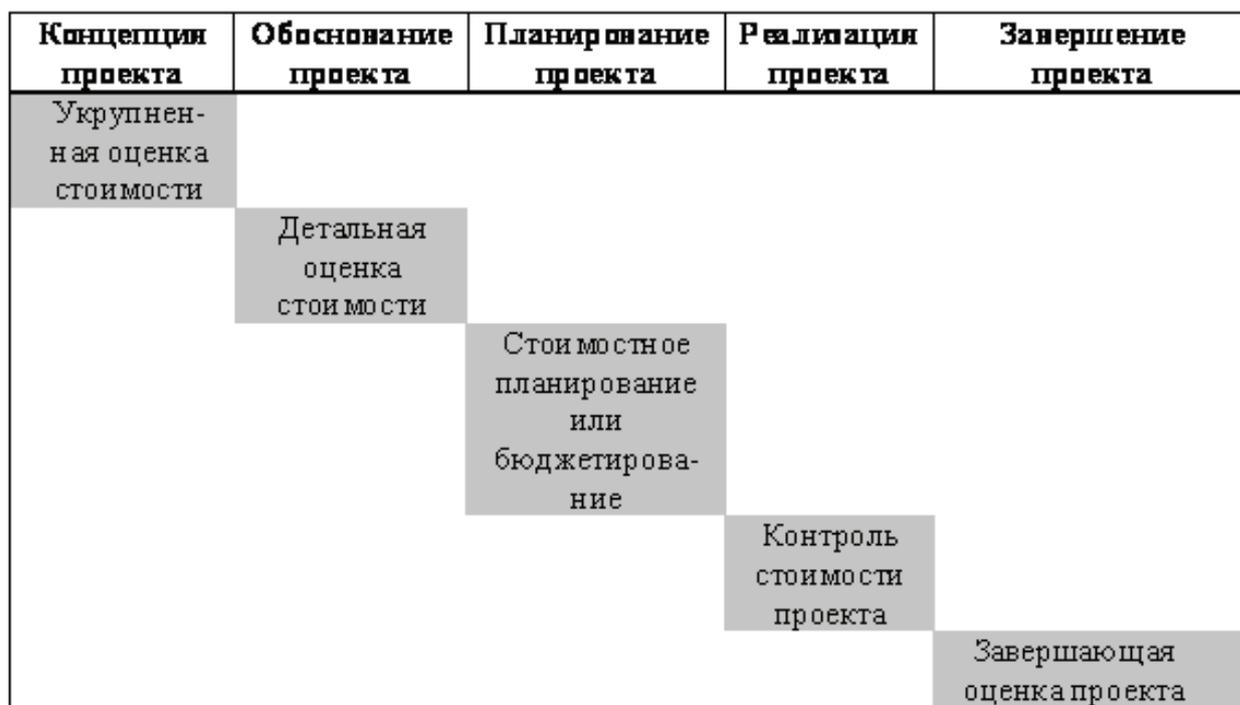
Рисунок 1. Управление стоимостью проекта на основе затрат LCC
